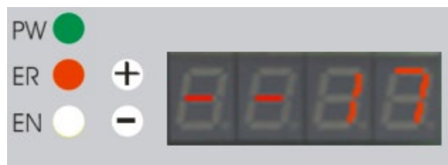
Abbildung 25: Beispiel einer Fehlermeldung auf der 7-Segment-Anzeige
